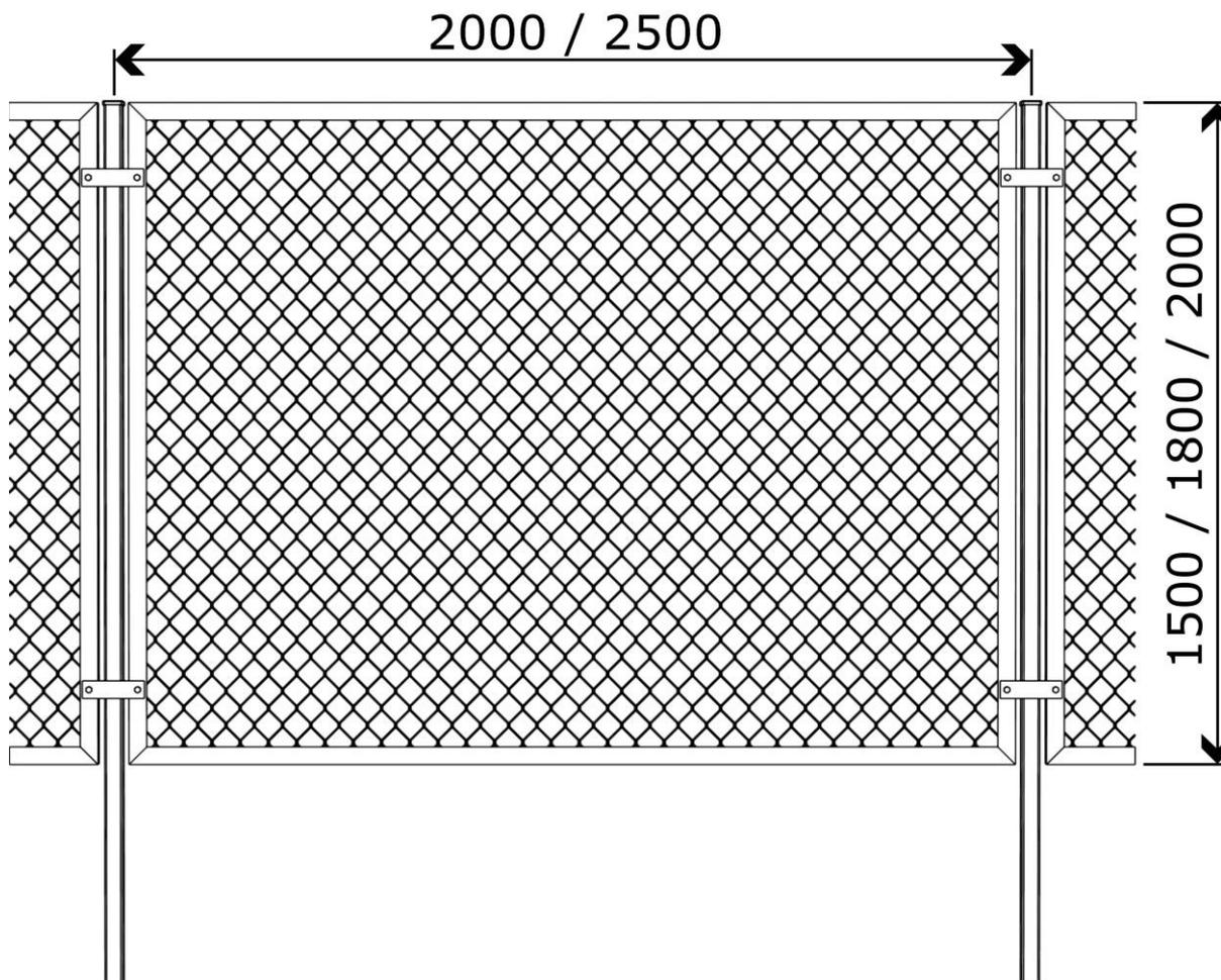
**Характеристики столбов**Столбы из трубы **60\*60\*2** с планками крепежом не комплектуются. Соединение сваркой по месту**Характеристики секций**Рама сделана из уголка **40\*40\*3,0**. Внутри сетка рабица с ячейкой **50\*50\*1.8**.**Антикоррозионная защита**
