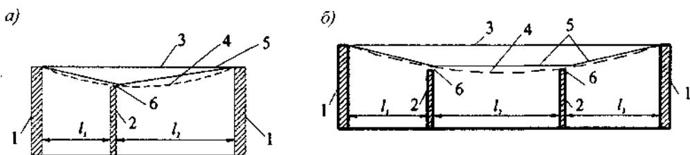
*a - одной в пролете; б - двух в пролете; l - несущие стены (или колонны); 2 - капитальные перегородки; 3 - перекрытие (покрытие) до приложения нагрузки; 4 - перекрытие (покрытие) после приложения нагрузки; 5 - линии отсчета прогибов; 6 - зазор*
