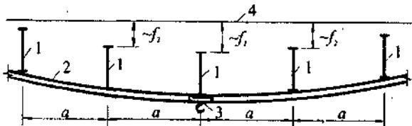
1 - стропильные конструкции; 2 - балка подвесного кранового пути; 3 - подвесной кран; 4 - исходное положение стропильных конструкций;  $f_1$  - прогиб наиболее нагруженной стропильной конструкции;  $f_2$  - прогибы смежных с наиболее нагруженной стропильными конструкциями
