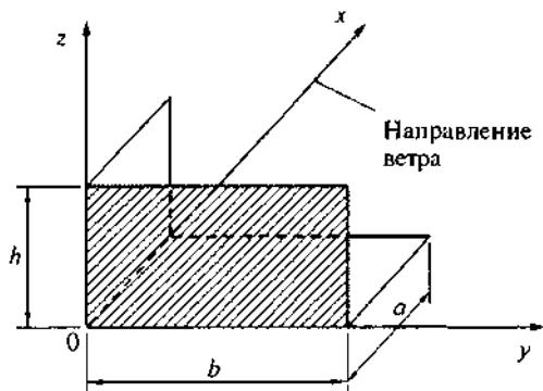
Рисунок 11.2 - Основная система координат при определении корреляции  $v$
